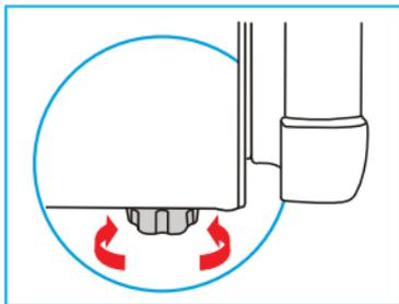
Este procedimento deve ser utilizado para corrigir pequenos defeitos de nivelamento da superfície onde o aparelho está sendo instalado.
